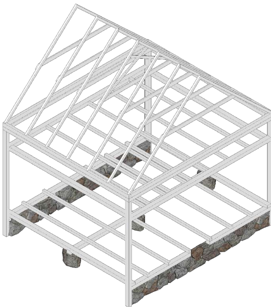
Figura 1 – Esquema estrutural da edificação com vigas, pilares e fundações (2022). Fonte: Autores
