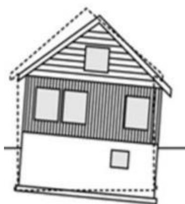
Figura 2 – Recalque diferencial com distorção uniforme, quando ocorre um movimento angular uniforme na estrutura, gerando transtornos estéticos e usuais na construção, porém sem afetar a segurança (2012).
