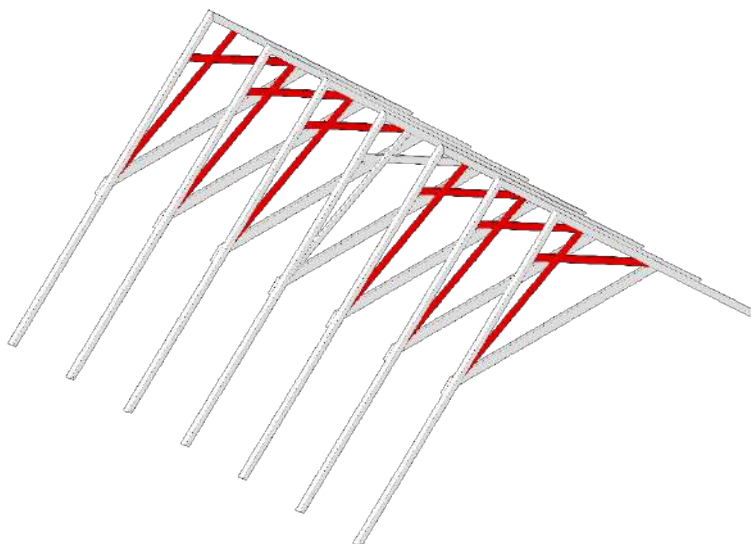
Figura 4 – Esquema estrutural da cobertura, onde os travamentos marcados em vermelho devem ser adicionados (2022).
